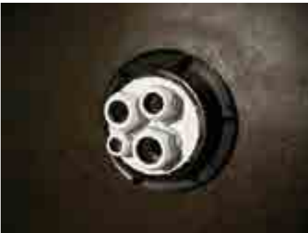
4. HL801 boru geiş parasını civatalarla sabitledikten sonra, hazırlanan boru contasına (HL800) yerleştirin, boru geiş parasının içine oturtun, güvenlik somununu sıkıştırın.
